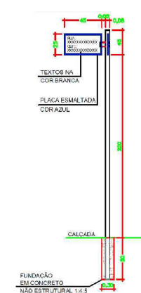
DETALHAMENTO DA PLACA PARA CRUZAMENTOS DE RUA (VISTA FRONTAL) MEDIDAS EM cm
