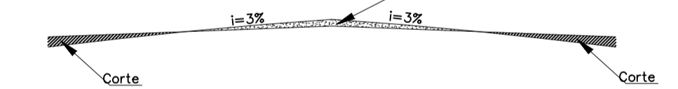
FIG. 03 - IMPLANTAÇÃO MEIO FIO E COLCHÃO DE AREIA
